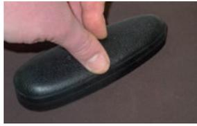
11. Sandpapier Nr.80 auf eine ebene Fläche legen und die Schaftkappe (G) durch leichten Druck in der Mitte leicht plan schleifen, bis sich die Schaftkappe (G) auf die Stahlschiene (A) am Schaft stramm aufschieben lässt. Jedoch ist darauf zu achten dass die Hohlschiene (E) nicht mit abgeschliffen wird.
