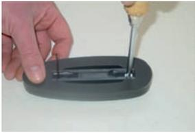
9. Schaftkappe (G) flach auf der Arbeitsfläche ablegen und sicherstellen das die Distanzscheiben (F) richtig über den Schraubenlöchern liegen.
