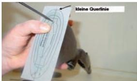
3. Schablone (H) über der Mittellinie zentrieren und die kleine Querlinie am oberen Ende des Schaftes anlegen. Den Mittelpunkt des oberen Schraubenloches mittels Reismadel anstechen und kornen.
