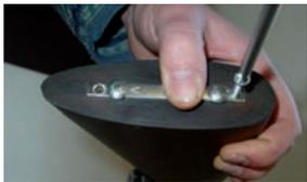
4. Mit einem Bohrer 3,2mm das obere Loch bohren, die Stahlschiene (A) mit einer Schraube (B) und dem Pfeil nach unten leicht anschrauben.
